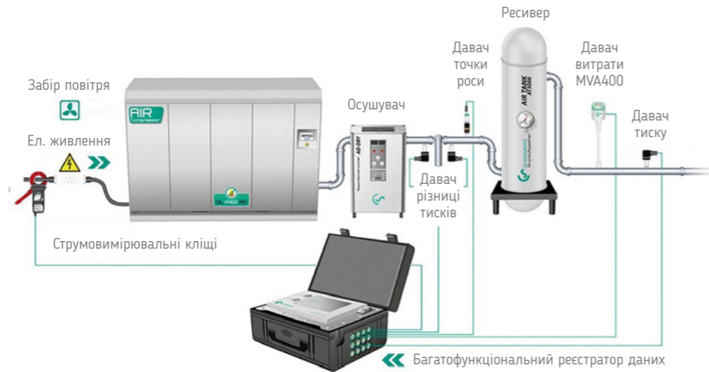
Рисунок 6.28 – Приклад застосування вимірювального обладнання під час проведення аудиту систем стисненого повітря
