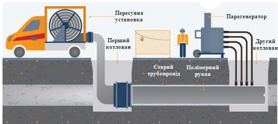
Рис. 2.9 Санація трубопроводу полімерним рукавом
