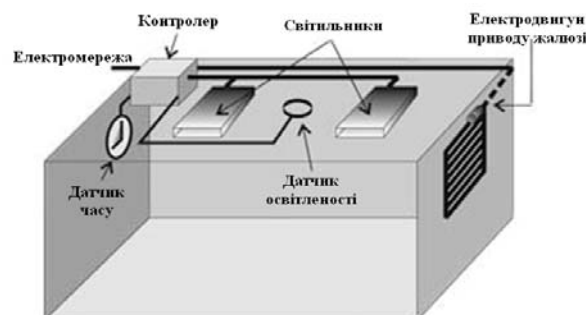
Рис. 4.8 Система керування освітленням в приміщенні
