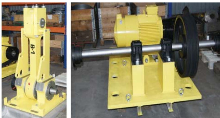
Рис. 1.18 – Вигляд вібраційного модуля приводу колосникової решітки котла BWE
