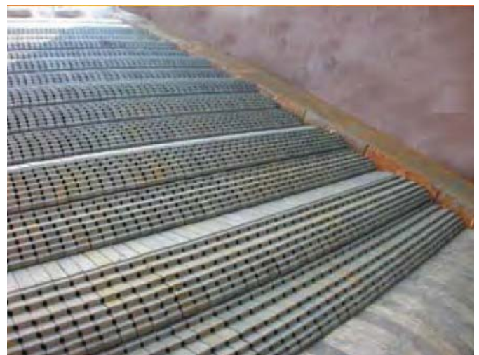
Рис. 1.5 – Колосникова решітка парового котла компанії Hurst
