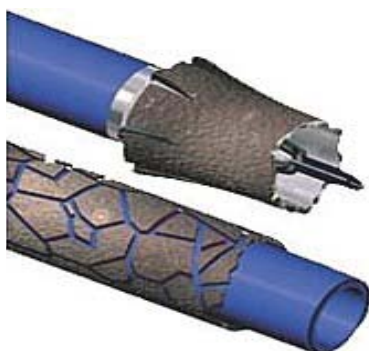
Рис. 2.7 Санація з руйнуванням старого металевого трубопроводу
