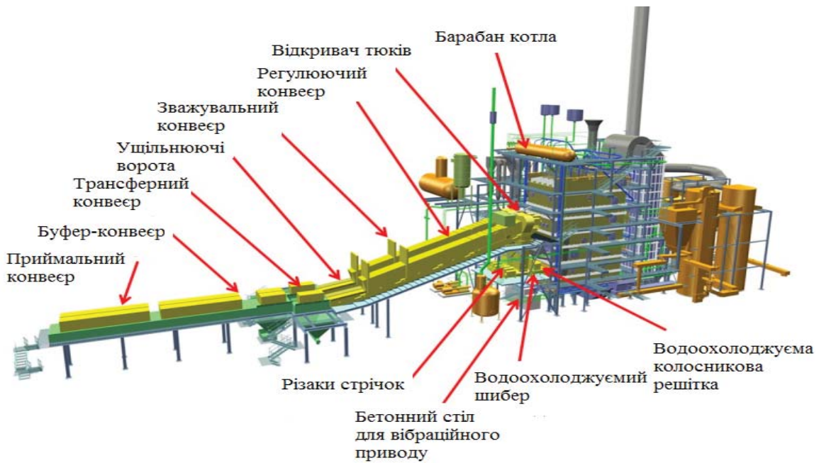
Рис. 1.9 – Загальний вигляд котельного агрегату BWE (модель)
