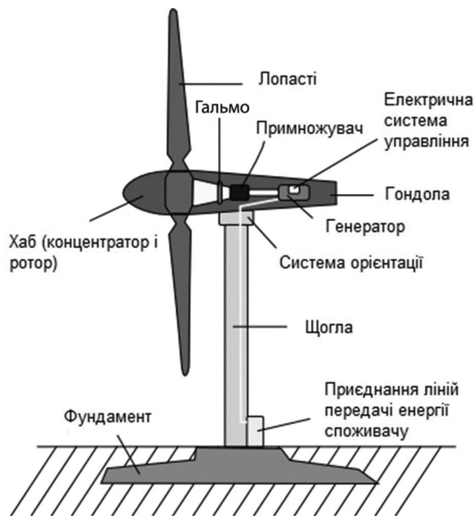
Рисунок 8. Принцип роботи вітрових турбін
